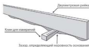
Рис. 1. Измерение неровности основания
