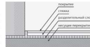
Рис. 14. Стяжка на разделительном слое
