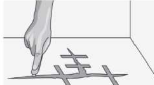
Рис. 2. Мелкие трещины сначала необходимо расширить до такой степени, чтобы жидкая смола (двухкомпонентная для ремонта трещин) могла легко проникать в них
