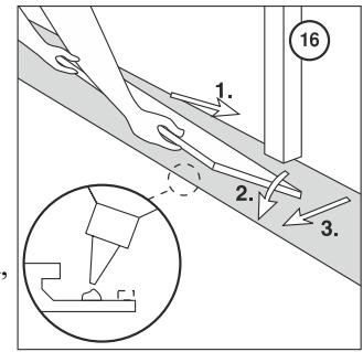
Если требуется вырезать сквозные отверстия под трубы, отмерьте доску до нужной длины или ширины. С помощью разметочного угольника отметьте на доске диаметр трубы.
