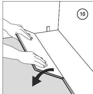
Установите первую доску следующего ряда (**рис. 10**) под небольшим углом к доске предыдущего ряда и уложите её на пол. Если между соединяемыми досками имеется некоторый зазор, убедитесь, что паз доски предыдущего ряда чистый.
